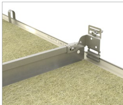
Om de haaksheid van het systeem te waarborgen, wordt geadviseerd om elk hoofdprofiel en elk tweede tussenprofiel aan de wand te bevestigen middels een 90° beugel.
